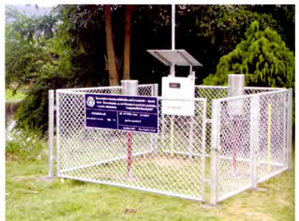
ภาพระบบเตือนภัยและการเตือนอัตโนมัติที่สถานีสนาม
